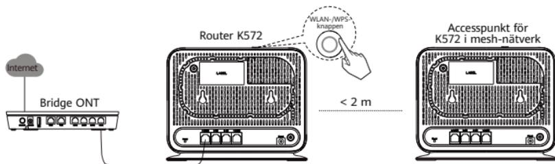
Vänta tills indikatorn för accesspunkten för K572 i mesh-nätverket lyser med ett fast vitt sken, vilket indikerar att parkopplingen har slutförts.
